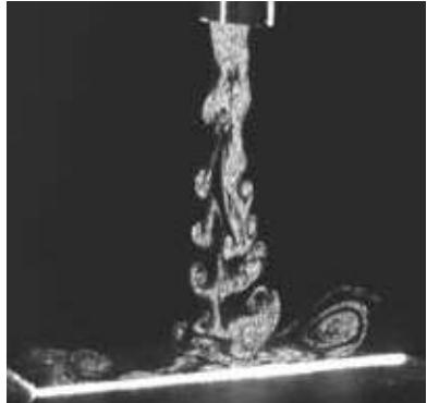
▲ $0.37\mu\text{m}$  単分散試験粒子PSLの可視化画像(右は粒子速度解析画像PIV)
