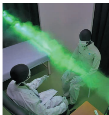
▲エアセパレート気流の可視化
