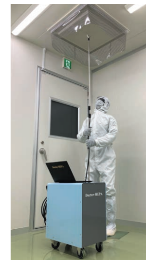
▶Doctor-HEPAによる測定 (パンチングフェイスありの場合)
