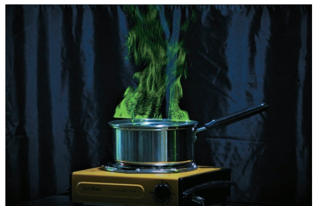
▲レーザー光による鍋の水蒸気の可視化
