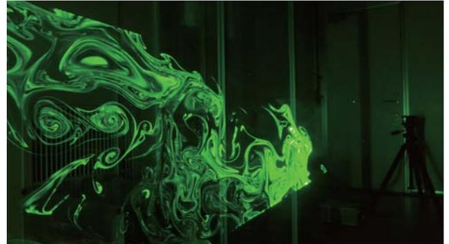
▲レーザー光による気流可視化
