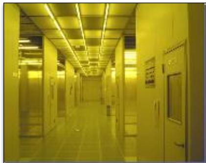
工業製品の製造工程で用いられるインダストリアルクリーンシステムは主に空気中の浮遊微粒子が管理対象となります。半導体製造工程はパターンの微細化が進み、制御対象となる微粒子の粒径は0.1 $\mu$ m以下となる場合もあります。さらに製造環境に必要な温湿度、室圧、気流、ケミカルガス成分なども制御されたクリーン空間が求められています。
