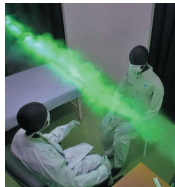
▲エアアセパレート気流の可視化
