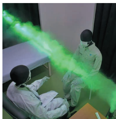
▲エアセパレート気流の可視化
