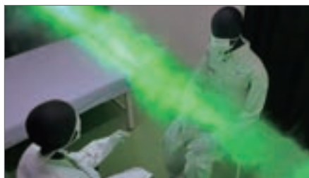
エアセパレート気流の可視化
